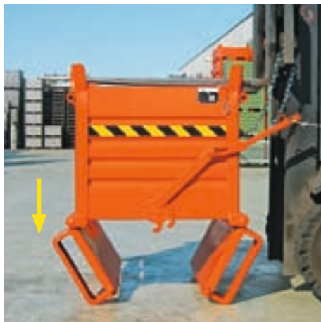
NELLE IMMAGINI IN SEQUENZA, ESEMPIO DI CHIUSURA DEL CONTENITORE A FONDO APRIBILE. AN EXAMPLE OF CLOSING A CONTAINER WITH OPENABLE BOTTOM IS SHOWN IN THE FOLLOWING SEQUENCE OF IMAGES.
